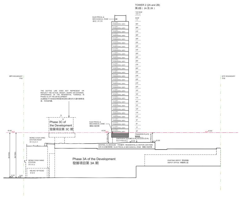
毗連建築物(第2座(2A及2B))的一段緊急車輛通道為香港主水平基準以上36.200米。
