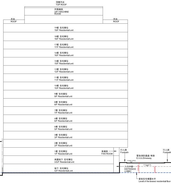
1. 毗連建築物的一段緊急消防車道,為香港主水平基準以上12.5米至13.85米。
