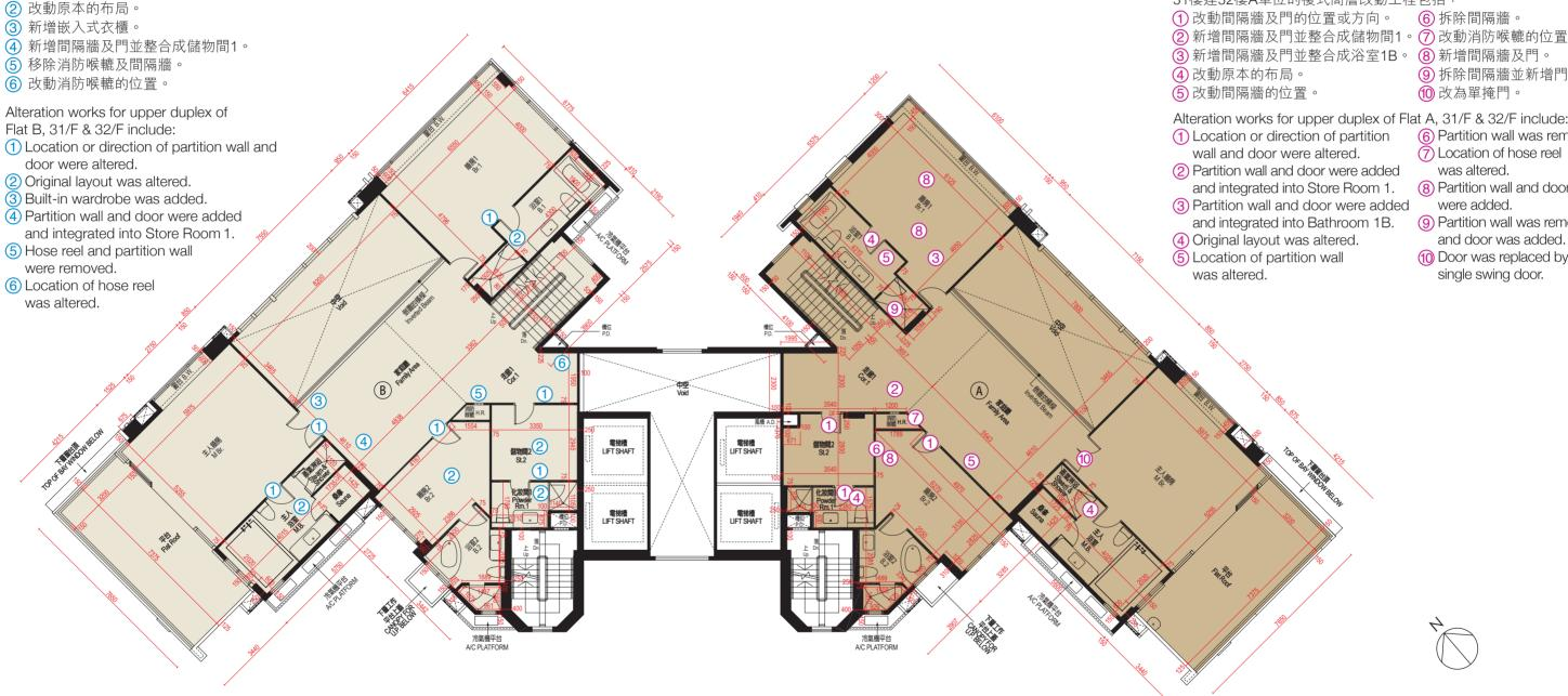
單位 Flat 每個住宅物業 樓層 Floor Each Residential Property Α В 樓板(不包括灰泥)的厚度(毫米) 150, 200 150, 175, 200 Thickness of Floor Slab (excluding plaster) (mm) 32樓 32/F 層與層之間的高度(毫米) 3500 3500 Floor-to-Floor Height (mm)
