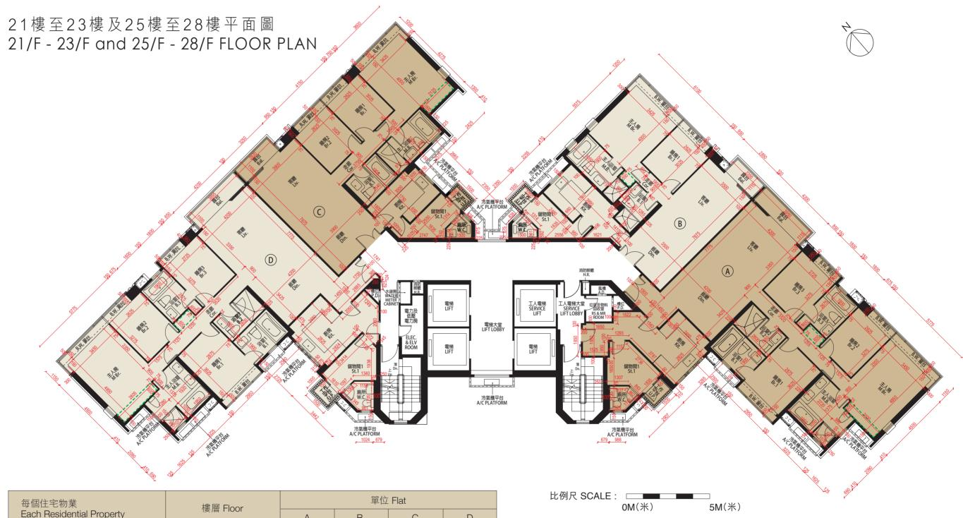
Each Residential Property В С Α D 21樓至23樓及25樓至27樓 樓板(不包括灰泥)的厚度(毫米) 150 150 150 150 21/F - 23/F, 25/F - 27/F Thickness of Floor Slab 28樓 (excluding plaster) (mm) 150, 175 150, 175 150, 175 150, 175 28/F 21樓至23樓及25樓至27樓 21/F - 23/F, 25/F - 27/F 3150, 3500 | 3150, 3500 | 3150, 3500 | 3150, 3500 層與層之間的高度(毫米) Floor-to-Floor Height (mm) 3150, 3300, 3150, 3300, 3150, 3500 28樓 3150, 3500 28/F
