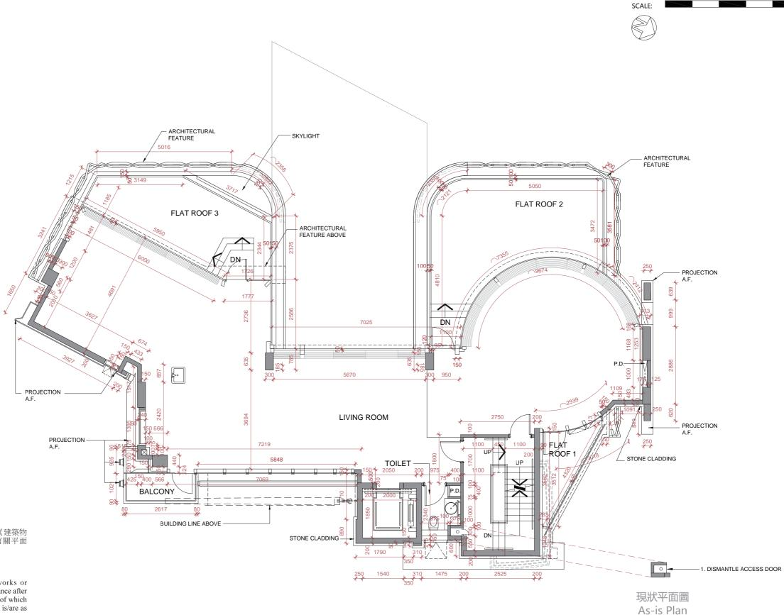
註: 此部份因在發展項目落成後進行小型工程或獲《建築物 條例》豁免的工程而有所改動,現狀請參閱有關平面 (2011) 並等地動机下: 圖。該等改動如下: 1. 拆除檢修門
