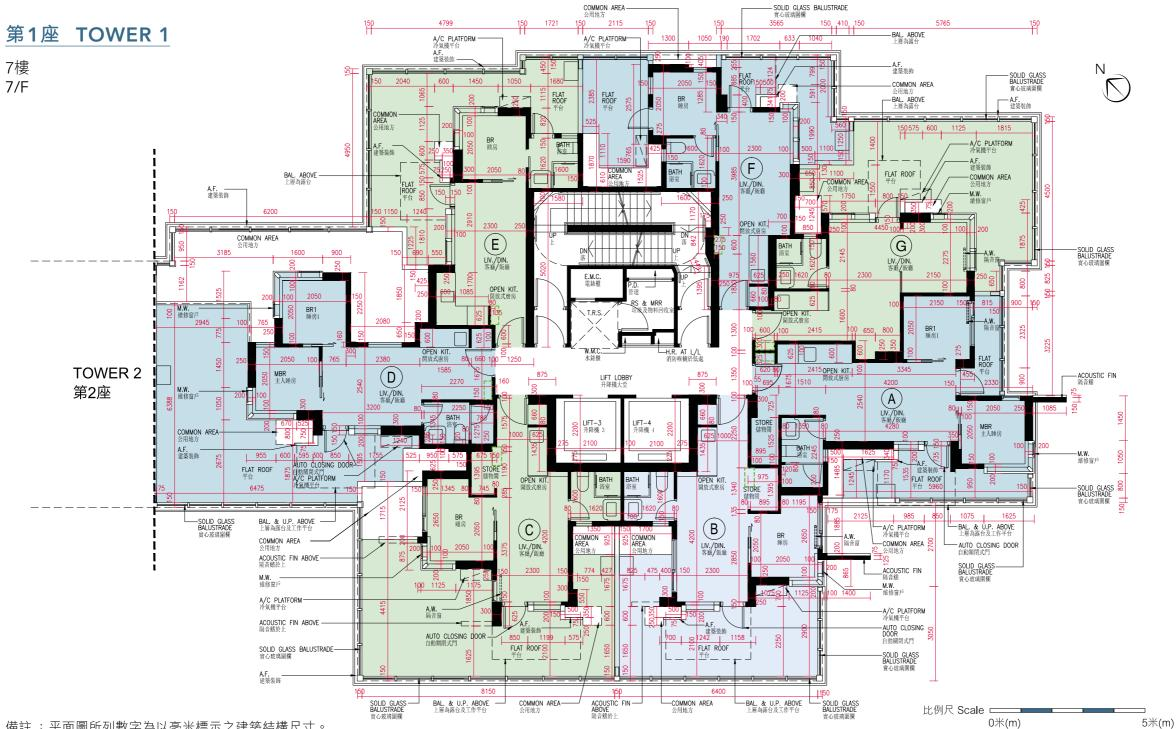
備註:平面圖所列數字為以毫米標示之建築結構尺寸。
