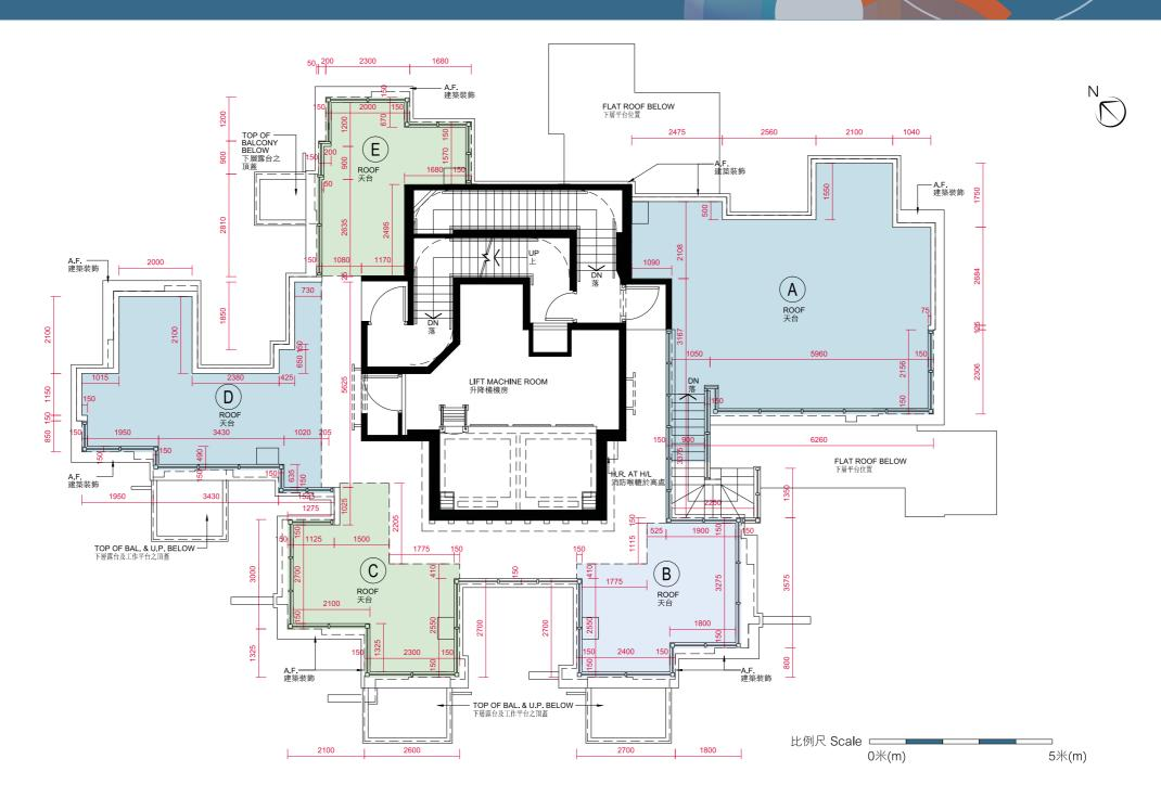
備註 : 平面圖所列數字為以毫米標示之建築結構尺寸。 Note : The dimensions of floor plans are all structural dimensions in millimeter.
